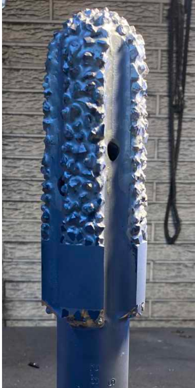
SJ-R 2 deg taper Med WC Chips .035" taper per side per inch
