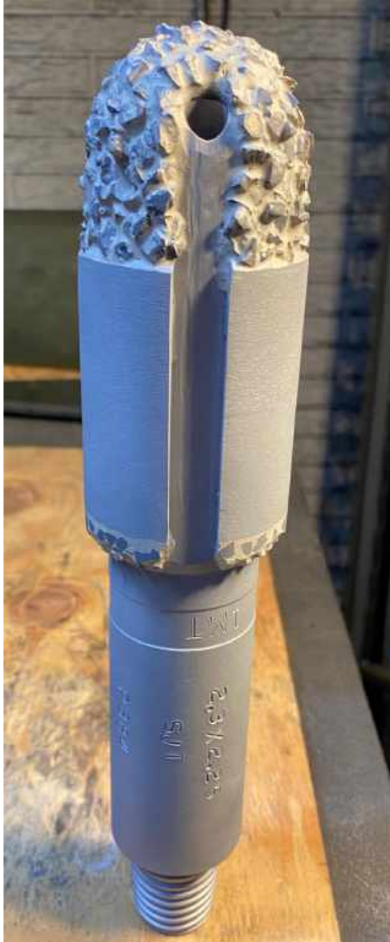
SJ-R 2 deg taper Med WC Chips .035" taper per side per inch
