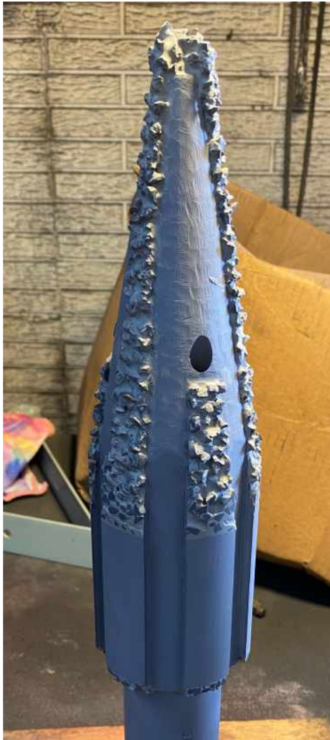
SJ-TT 15 Deg Taper / Med WC Chips
